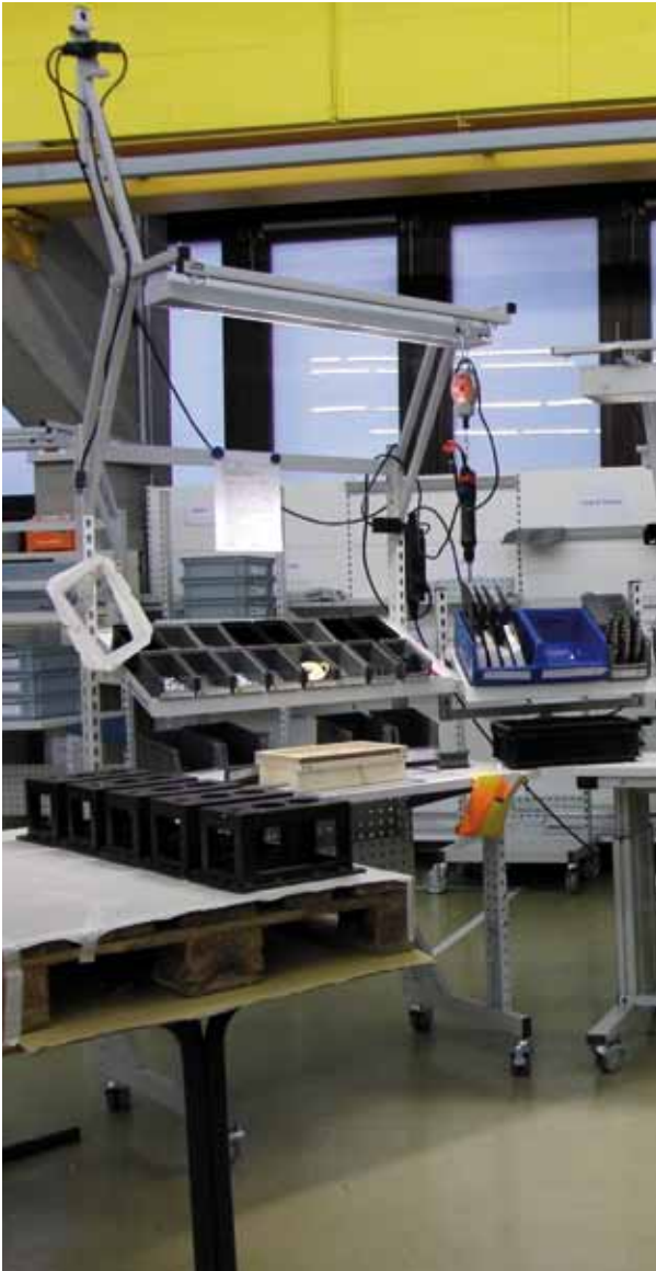
Modular aufgebaute Arbeitsplätze im IE-Labor
